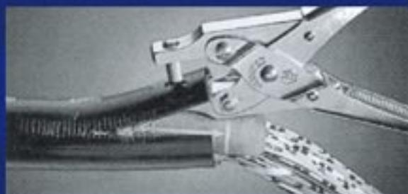
Mit Hilfe eines Kabelmantelschneiders wird eine ca. 50 mm lange und 25 mm breite Lasche in den Kabelmantel geschnitten. Dann wird die Isolierplatte in Pfeilrichtung bis zur Quermarkierung unter den Kabelmantel geschoben. Zur Aufnahme der Grundplatte mit Gewindebolzen wird der Kabelmantel nun gelocht. Hierzu empfehlen wir unsere Lochzange C-4039. Dieses handliche Werkzeug ist korrosionsfest und der gehärtete Lochbolzen gewährleistet eine lange Lebensdauer.
