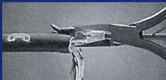
Die obere und untere Lasche der Schirmverbindungsklemme werden im Bereich des Verbindungssteiges bis zum Eindringen der Haltezähne in die Kabelisolation gepresst.
