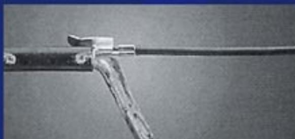
... und bis zum Verbindungssteg auf den Kabelmantel geschoben.
