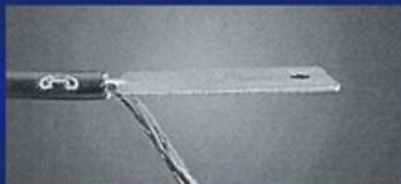
Mit dem Montagewerkzeug wird zunächst der Abstand zwischen den Adern und der Abschirmung des Kabels vergrößert.
